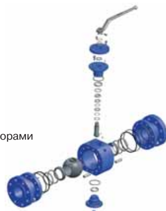
Конструкция крана с двумя опорами шара
