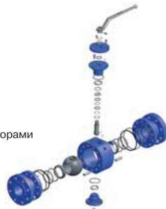
Конструкция крана с двумя опорами шара
